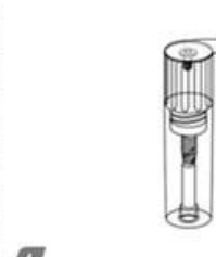
4 El tornillo de cobertura se aloja en la tapa del contenedor bajo un sello Tyvek termosellado.
