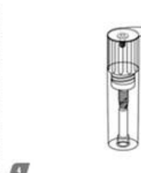
4 O parafuso de cobertura está alojado na tampa do recipiente sob uma película Tyvek selada a quente.
