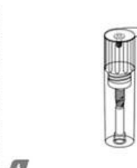
Śruba zamykająca znajduje się w zatyczce pojemnika pod termozgrzewalną osłoną z Tyvek.
