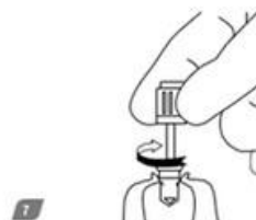
Wyjąć śrubę zamykającą z zatyczki fiolki i przykręcić do implantu za pomocą sterownika protetycznego (07-EG05; 07-EG10; 07-EG20; 02EGM10; 02EGM05).
