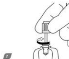
7 Z zamaška fule odstranite pokrovček in ga s protetičnim ključem za proteze privijte na vsadek (07-EG05; 07-EG10; 07-EG20; 02EGM10; 02EGM05)
