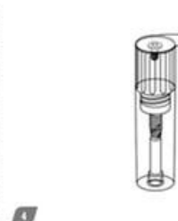
4 Pokrivni vijak je nameščen v pokrovčku posode pod toplotnim pečatom Tyvek.
