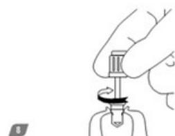
Távolítsa el a fém dugóról a fedőcsavart, és csavarja rá a rendszerre a csavarhúzóval.
