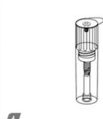
4 Śruba zamykająca znajduje się w zatyczce pojemnika pod termozgrzewalną osłoną z Tyvek.
