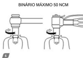
6 Conectar o driver de implante (nivelar o driver de implante correspondente com o tipo de conexão do implante) e aparafusar a baixa velocidade (10-15 rpm)
