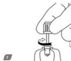
7 Entfernen Sie die Abdeckkappe vom Verschlussstopfen und schrauben Sie sie mit dem Prothetikendrehher (07-EG05; 07-EG10; 07-EG20; 02EGM10; 02EGM05) auf das Implantat.
