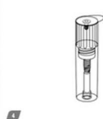
4 Die Verschlusschraube befindet sich im Behälterdeckel unter einem heißversiegelten Tyvek-Siegel.
