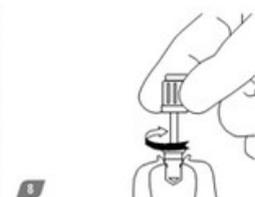
8 Retirar o parafuso de cobertura da ficha fala e aparafusá-la no sistema com a chave de fendas.
